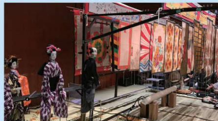
人形芝居ならではの舞台転換装置「はったんがえし」。奥行き5メートルの間に何枚も宙を重ねて吊り、三味線や太鼓に合わせて次々に奥側のバックを変えて見せる。
